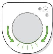
Amikor a robot érzékelni fogja a portartályt, ki kell üríteni, hogy a fénygyűrű kijelző pirosan világít a hátsó rész felé irányuló törölő mozdulatokkal.
