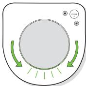
Atunci când robotul detectează că trebuie golit coșul colector, inelul luminos se va aprinde cu roșu cu o mișcare de curățare către partea din spate.
