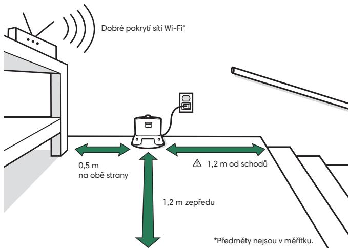
**VAROVÁNÍ:** Abyste zabránili riziku pádu robota ze schodů, ujistěte se, že se nabíjecí stanice nachází nejméně 1,2 metru od schodů.
