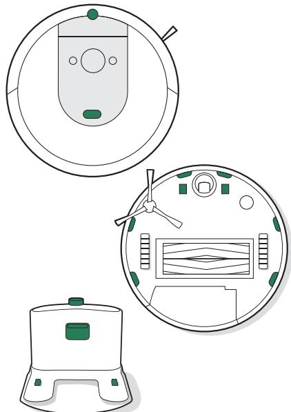
**Důležité:** Nestříkejte čisticí prostředky ani vodu přímo na senzory nebo do otvorů pro senzory.
